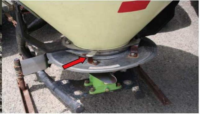
●タンク下部のレバーで肥料の散布量を調整する
